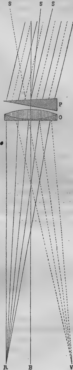
Рис. 38. Полученіе спектра при посредствѣ объективной призмы.
